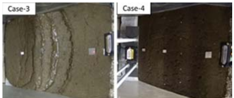
図 8 背面水位 20cm 時点 (右側がのり肩、上方から撮影)
