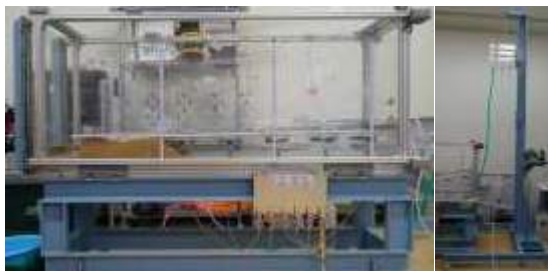
図1 実験装置（左：実験土槽 右：定水位昇降装置）
