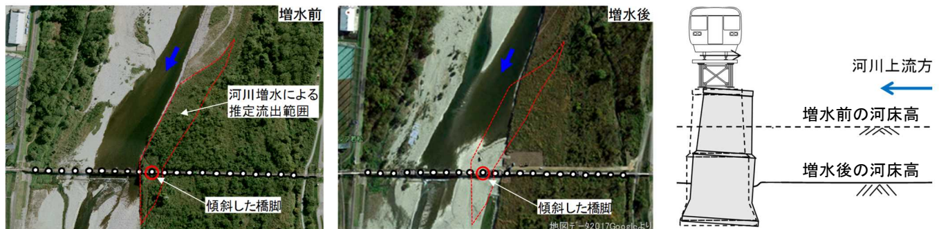
図-1 A橋りょう橋脚基礎洗掘事象の概要
