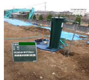
写真2 現場透水試験の様子
