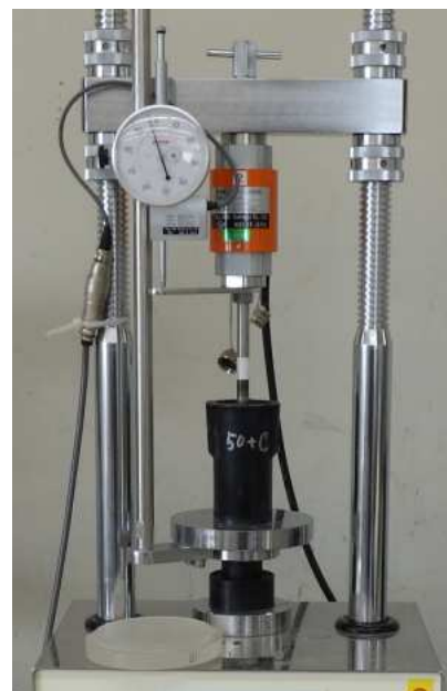
写真-1 針貫入試験の状況
