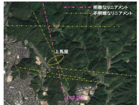
写真-1 上馬屋地区における地形判読とリニアメント
