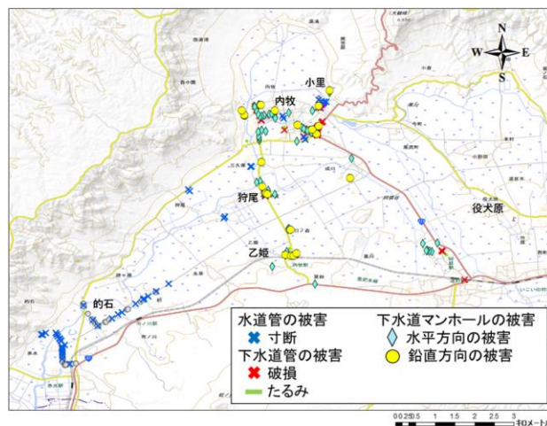
図 2 上・下水道の被害発生箇所
