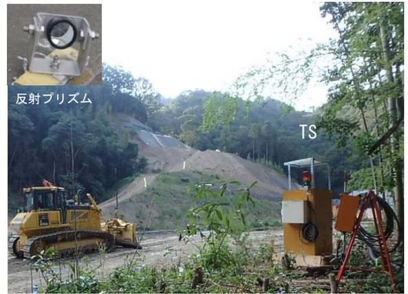
写真1 3次元変位計測システム
