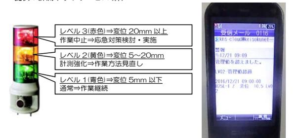
図3 計測データ画面及び警報装置事例
