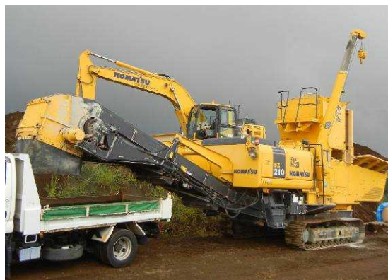
写真-2 使用した自走式改良機
