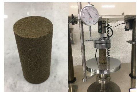
写真1 供試体と一軸圧縮試験機
