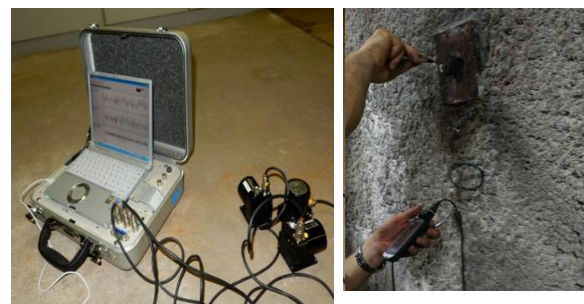
図2 多重パラメータ計測(左) 加速度計(右)
