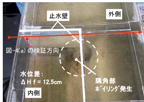
写真-1 模型実験の状況：ポイリング発生時 \Delta H_f = 12.5\text{cm}
