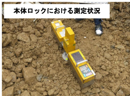
写真-2 SRIDによる現場密度測定状況
