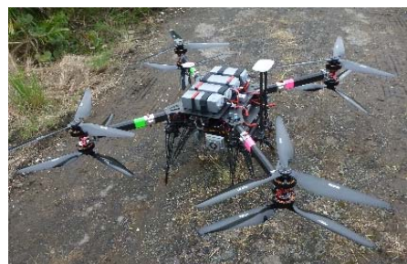
図2: UAV 計測機器: SPAIDER_eX (ルーチェサーチ(株))
