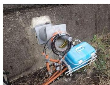
写真-3 無載荷状態の荷重計
