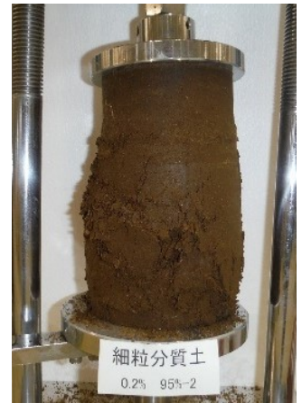
写真-1 破壊状況
