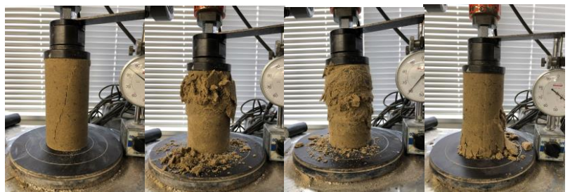
写真-2 一軸圧縮試験終了後の破壊状況 (豊浦砂)
