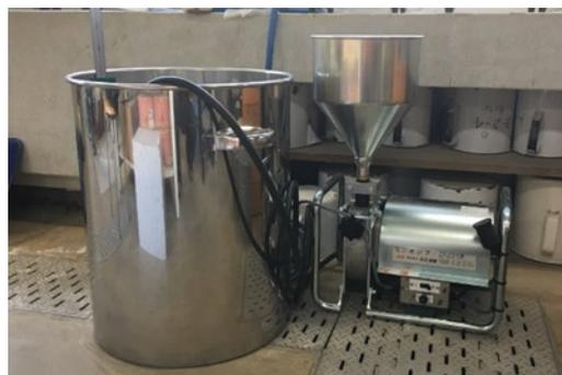
図1 三次元注入試験装置
