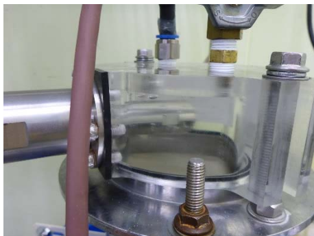
図-1 超音波発生装置を装着した透水試験機
