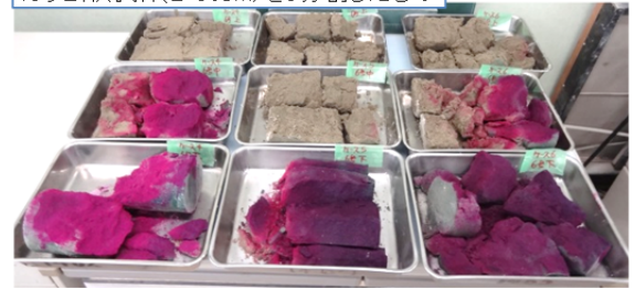
図-3 供試体の浸透状況(左からCASE4, 5, 6)
