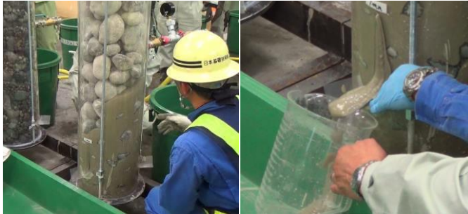
写真3 注入試験状況・スリット排出状況
