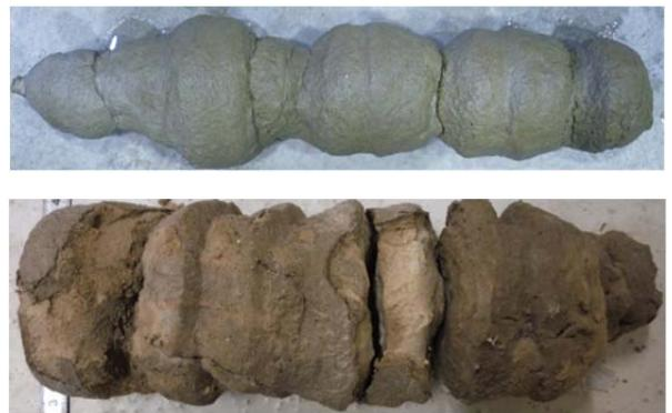
図-4 改良体の出来形 (外径 24 mm)
