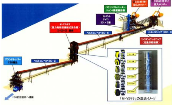
図-5 CSG 製造プラント
