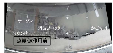
図-5 Case1 法先部の沈み込み
