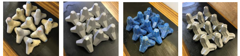
写真-1 実験対象ブロック模型：4 種類 (左から T ブロック, K ブロック, R ブロック, A ブロック)
