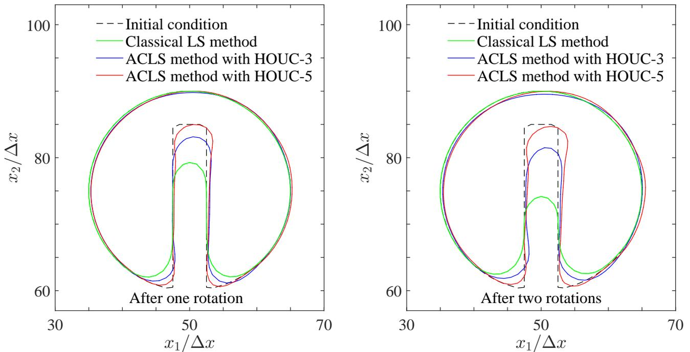
図 1: Zalesak ディスク問題における, 1 回転および 2 回転後のディスク形状.  $\Delta x$  は計算格子サイズを表す.
