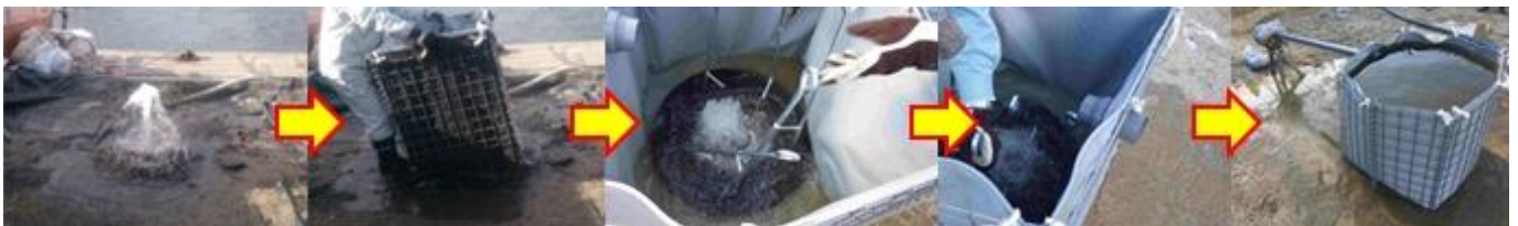
写真-4 噴出口を模擬した箱型鋼製枠による釜段工の設置確認実験
