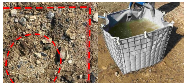
写真-3 凹凸箇所での湛水実験(不織布 t=10mm)
