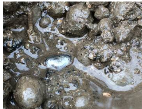
写真-1 石炭灰造粒物により浄化されたヘドロ土壌 (GCA 掘り返し)
