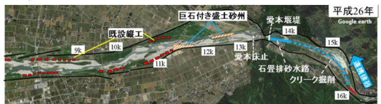
図-1 黒部川で検討している一連の交互砂州河道の回復技術
