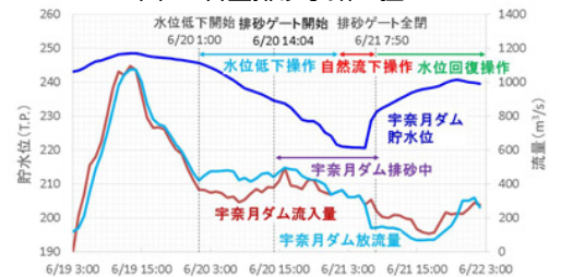
図-4 平均年最大流量程度の洪水(H25.9洪水)での連携排砂時の宇奈月ダム操作状況
