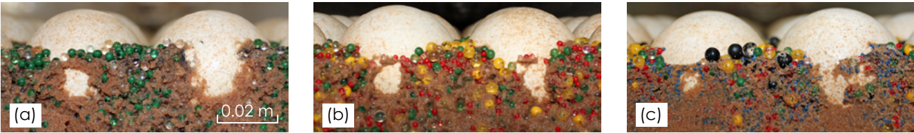
写真 -1 静的平衡状態における河床の断面図：静的平衡状態に到った後の河床の横断面を水路下流側から上流側に向かって撮影した写真である。(a) Case A, (b) Case B, (c) Case C である。
