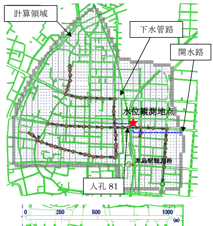
図2 解析領域と下水道施設、水路の配置 (ただし、背景は道路ラインデータ 4) )
