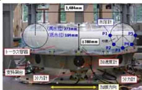
図1 試験体および機器の設置状況と寸法
