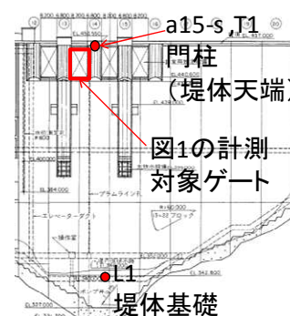
図2 堤体部の加速度計の配置
