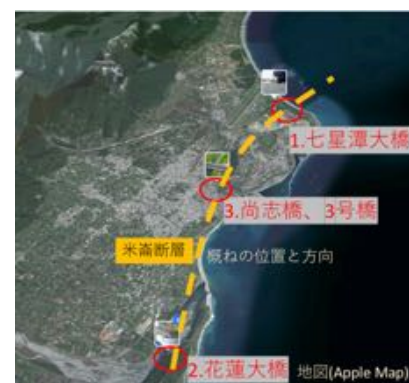
図-1 断層と被害橋梁の関係
