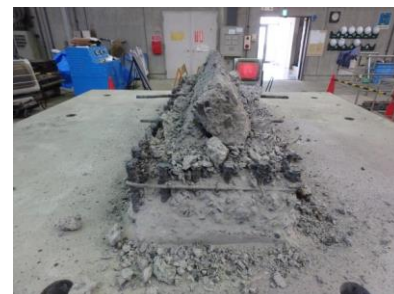
写真－４ 塑性ヒンジの様子
