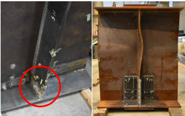
腐食あり・無補強 補強・接着不良あり
