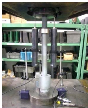
写真 1 押込み試験状況
