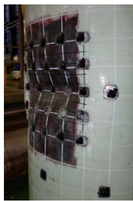
(試験前) 図－2 デントを有する鋼管の軸圧縮試験
