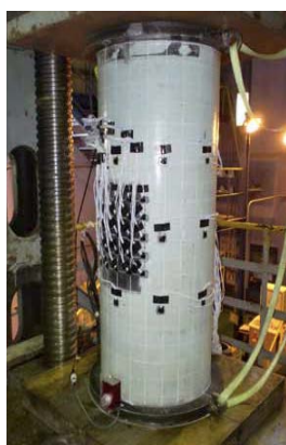
(試験前) 図－2 デントを有する鋼管の軸圧縮試験
