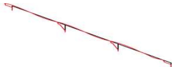
図7 解析結果 固有ベクトル (-30℃)
