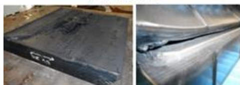
(B) 破断面 (C) ひび割れ部
