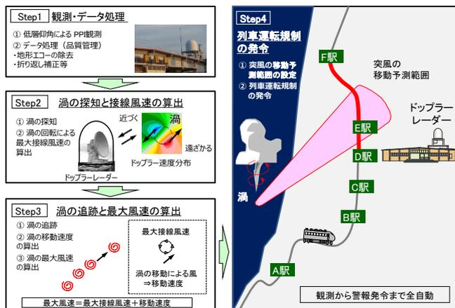
図1 突風に対する列車運転規制のフロー
