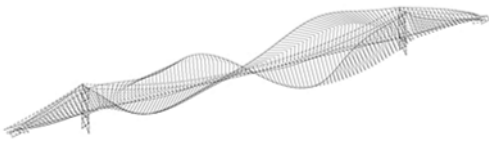
図-7 フラッター発生時の振動 (74 m/s)
