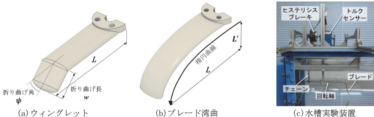
図-1 ウィングレット・湾曲を与えた VENUS ブレードおよび水槽実験装置
