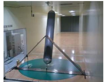
図1 斜円柱模型設置状況
