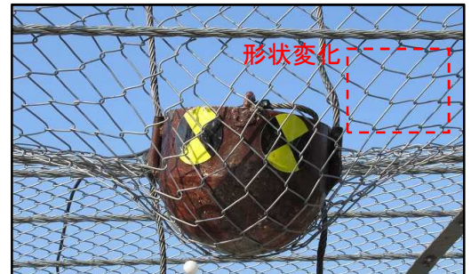
写真-1 ひし形金網の形状変化 (重錘衝突による実験時)
