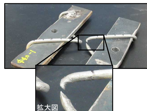
写真－4 線交点の破断状況
