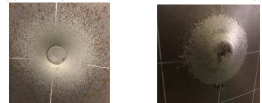
(b) No.7(板厚 9mm, 速度 60.78m/s : 非貫通)
