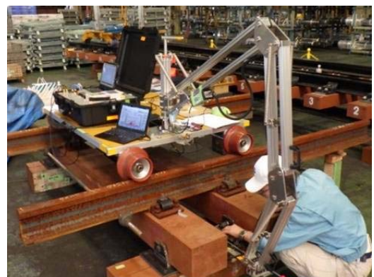
図4 まくらぎ受け部挿入用専用アーム
