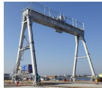
写真-2 100t吊橋形クレーン
