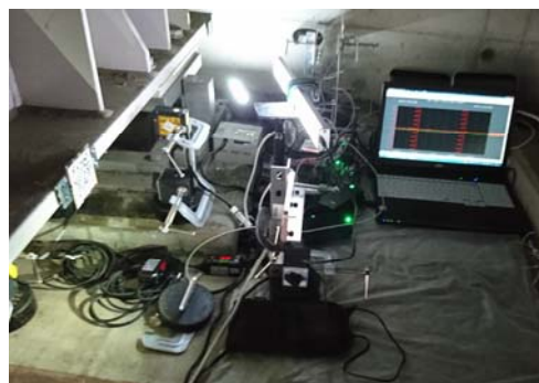
図-2 実際の計測の様子（ゴム支承 24時間計測）
