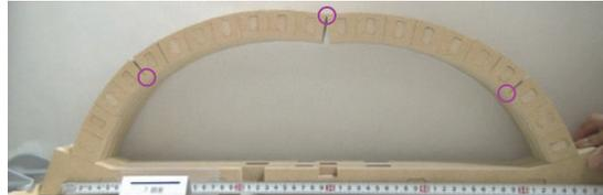
(a) 支点水平移動量  $dL=27.0\text{mm}$  ( $dL/L \times 100=5.4\%$ ) 【崩壊直前】
