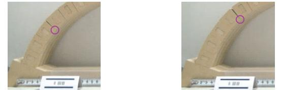
(a) 実験：支点水平移動量  $dL=22\text{mm} \sim 23\text{mm}$  のとき (8 回目)
