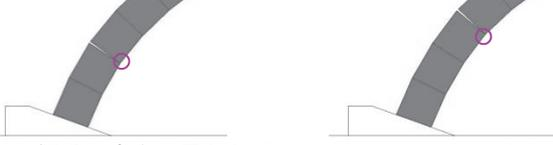
(b) 解析：支点水平移動量  $dL=14\text{mm} \sim 15\text{mm}$  のとき
