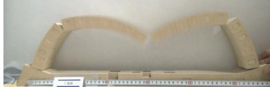
(b) 支点水平移動量  $dL=27.5\text{mm}$  ( $dL/L \times 100=5.5\%$ ) 【崩壊時】
